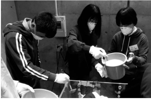
写真4 液状化実験の模型地盤を作製する参加者
